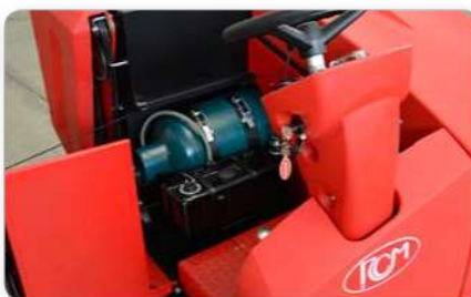
Impianto GPL LPG system Instalación de GLP
