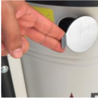
El aspirador esta equipado con un nuevo sistema de limpieza llamado JetClean® proyectado por Depureco. Gracias a la diferencia de presión entre el interior y el exterior del aspirador, el sistema genera un flujo de aire dentro del cartucho, sacando el polvo desde la superficie del filtro. Este es un método rápido y eficiente para mantener el filtro limpio durante las operaciones, sin parar el motor.
