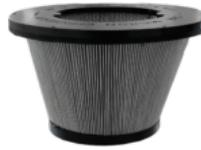
La filtración se asegura gracias a un filtro en cartucho robusto en poliéster. El cartucho es proyectado para llevar una grande superficie filtrante en un espacio compacto. De esta manera el aire puede atravesar el filtro aun si éste está sucio. El filtro esta certificado en clase M (BIA | EN 60335-2-69). Para las partículas hasta 1 micrón, preservando los motores y los operadores en los alrededores.
