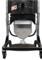
El material aspirado se acumula en un saco de plástico robusto llamado Longopac®. Este saco tiene un largo de 20 metros y esta enrollado bajo la cámara filtrante. Cuando el aspirador se para, el material baja automáticamente en el saco. Cuando el saco esté lleno el operador podrá sellarlo, cortarlo y preparar el polvo para el desecho. Después será posible preparar otro saco. Esta operación se realiza sin contacto entre operador y material.
