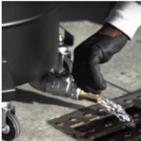
La descarga se realiza gracias a la fuerza de gravedad. En la parte inferior de la unidad hay una válvula que permite descargar fácilmente los líquidos y los detritos recogidos al interior del contenedor.
