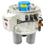
SP Sacudidor filtro en contracorriente de aire Filtro antiestático clase M (EN 60335-2-69), 3 cartuchos poliéster antiestático, 9 m 2 superficie filtrante
